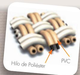
Composición en hilatura de poliéster de alta tenacidad recubierto de PVC
